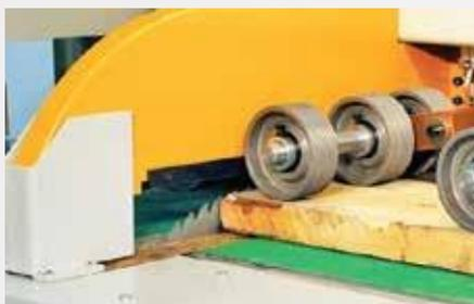
É uma serra que trabalha em destopo em uma máquina otimizador (em alta rotação e alto avanço), eliminando defeitos encontrados na madeira.
